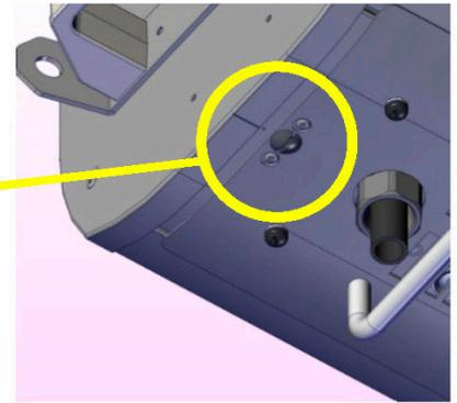
3 - Öffnen Sie den Lampensockel und trennen Sie die Erdverbindung (Faston-Steckklemme), die am Lampenfach angebracht ist.
