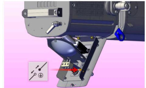
4 - Lösen und entfernen Sie die beiden Schrauben mit einem flachen Schraubendreher. Schieben Sie das Lampenfach heraus, um es vom Lampengehäuse zu lösen.
